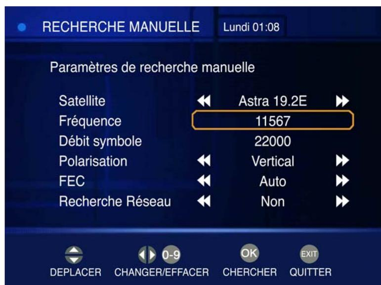
Ce menu permet d'effectuer une recherche par transpondeur en réglant les différents paramètres.
