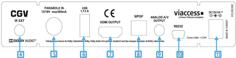
4. IR EXT : Entrée capteur infrarouge. Branchez un capteur infrarouge (non fourni) afin de dissimuler votre récepteur dans un meuble tout en continuant à utiliser votre télécommande.
