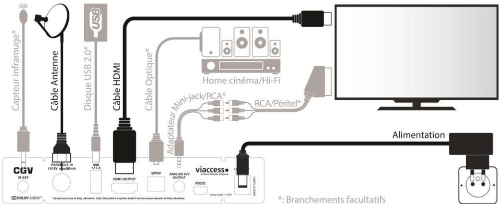
1. Raccordez votre parabole orientée sur ASTRA 19.2° EST sur l'entrée PARABOLE IN.
