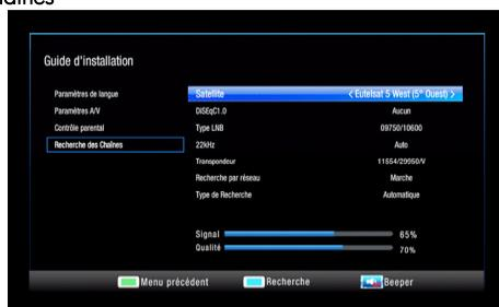
L'indication de **Qualité** doit être au moins à 50% pour que la recherche automatique fonctionne correctement. La fonction **Beeper** du **E-SAT HD-W4** (appuyez sur la touche **(MUTE)** pour l'activer/la désactiver) permet d'ajuster plus facilement la position de la parabole (plus le « Beep-Beep » est fort, meilleure est la réception).
