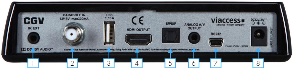
1. IR EXT : Entrée capteur infrarouge. Branchez un capteur infrarouge (non fourni) afin de dissimuler votre récepteur dans un meuble tout en continuant à utiliser votre télécommande.
