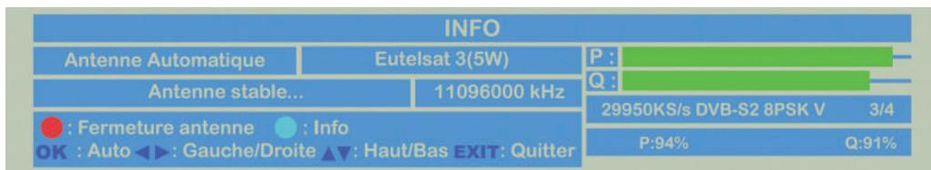
Lorsque l'orientation automatique de l'antenne est réussie, un double bip sonore est émis et cette barre d'information est maintenue affichée pendant 5 secondes, puis disparaît automatiquement en l'absence de commandes manuelles avec les touches directionnelles de la télécommande; la phase de démarrage de votre récepteur continu alors jusqu'à obtenir une image.
