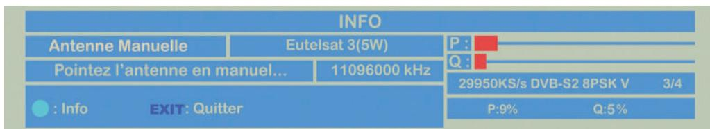
4. Référez-vous aux instructions de votre antenne pour la positionner. Référez-vous aux barres Signal et Qualité pour vous aider à positionner votre antenne. Le récepteur SATMATIC-HD émet un bip sonore continu lorsque le satellite est verrouillé. Appuyez sur la touche **EXIT** de la télécommande pour stopper le bip sonore continu émis par le récepteur SATMATIC-HD.
