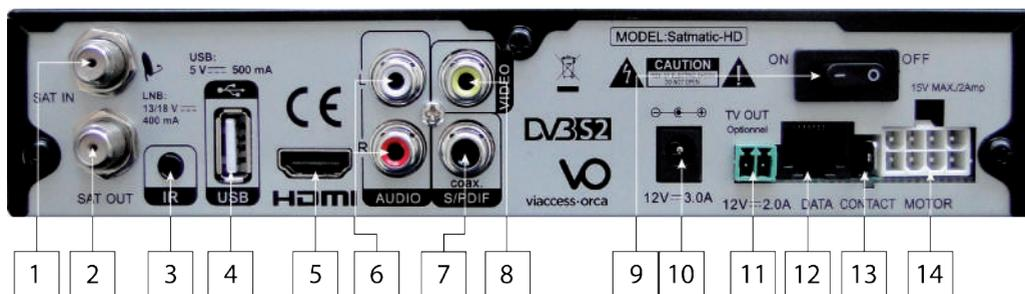
1. **PARABOLE IN:** Reliez ce connecteur à votre parabole à l'aide d'un câble adéquat.
