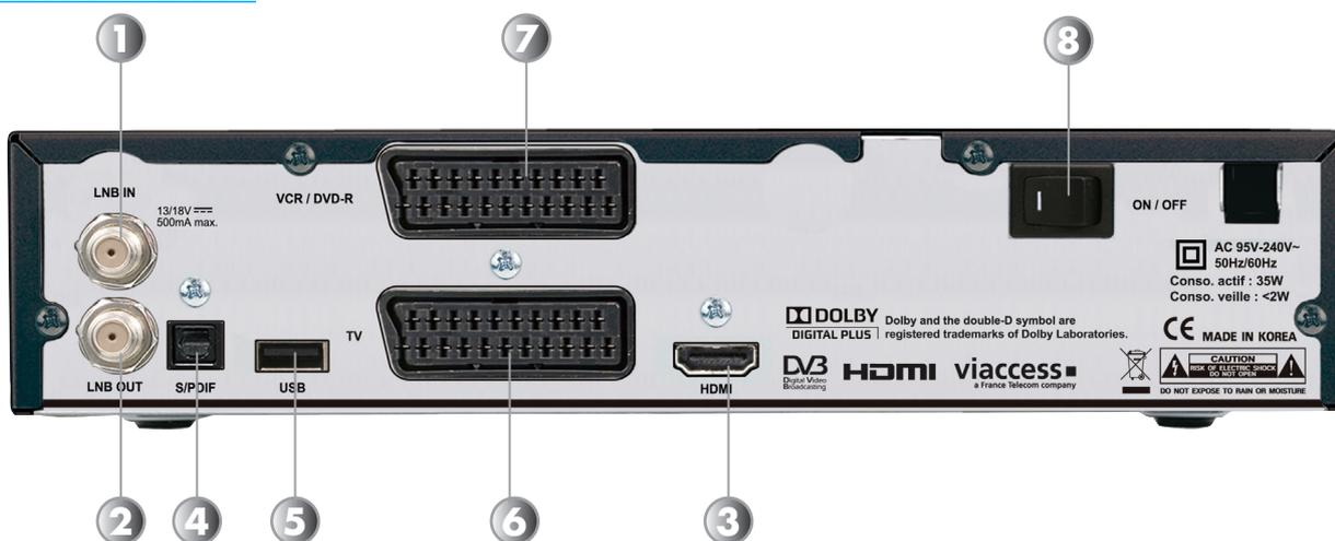
1. **Entrée LNB IN** : Entrée du câble coaxial provenant de votre parabole.
