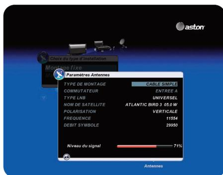
1. Sélectionnez le type de montage utilisé (commutateur DiSEqC, tête monobloc, ...).
